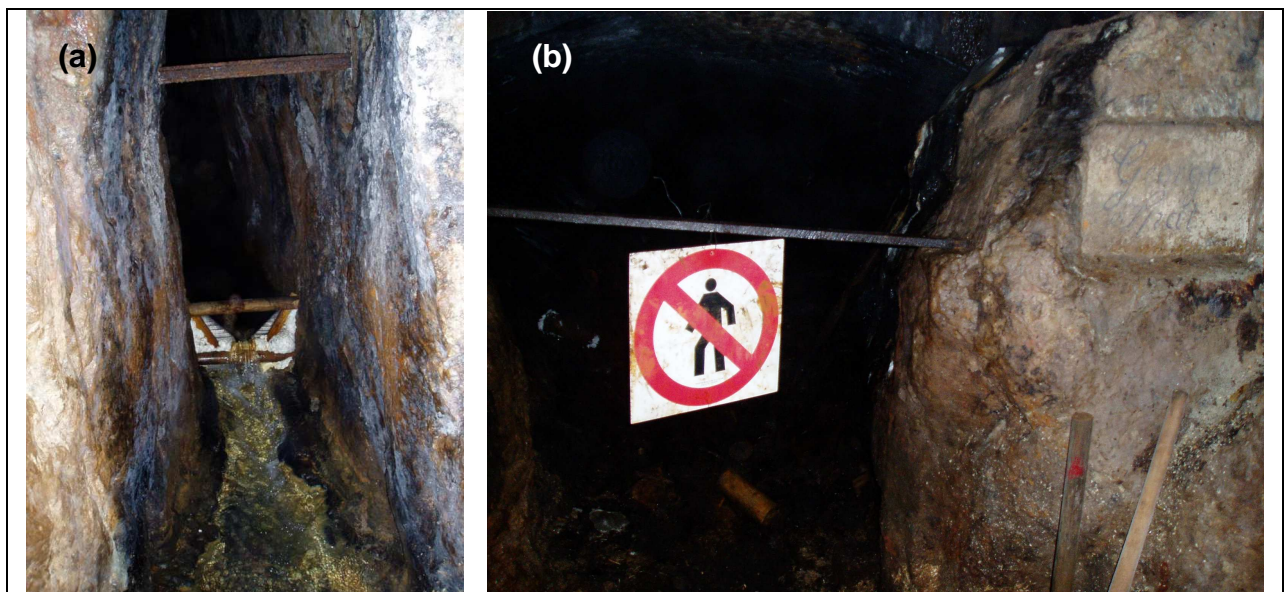
Abb. 22: Grubenwasser-Probenahmestelle W12. a) Installiertes Dreiecks-Messwehr. b) Verbotsschild nahe der Probenahmestelle.
